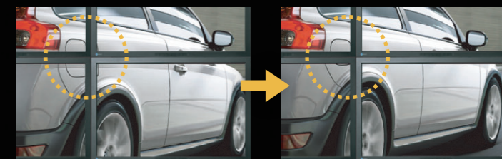
ベゼル補正なし ベゼル幅の分だけ表示画面が分離するため、映像全体がずれてしまい、表示が不自然に。 ベゼル補正あり ベゼル補正により、映像全体がスムーズに一体化して見え、自然な画面表示を表現。
