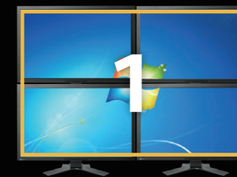
SLI Mosaic モード動作イメージ (4画面を仮想の1画面として認識)
