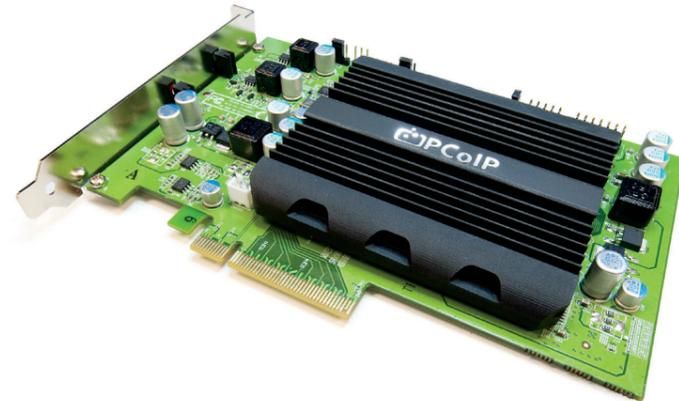
APEX 2800 PCoIP サーバオフロードカードは、CPU から PCoIP イメージエンコーディングの処理をオフロードする様に設計されており、この機能により CPU 使用率を低減し、アプリケーションパフォーマンスの向上を提供します。
