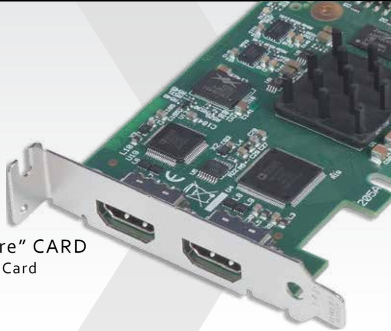
※画像は標準添付のロープロファイルブラケット装着時出荷時は ATX (標準) サイズブラケットを装着しています
