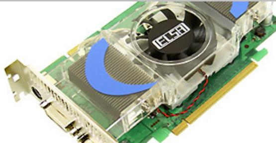
ELSA GLADIAC™ 776 GT Silent 256MB は、新開発のELSA E.S.C.S (Elsa Silent Cooling System) 大型2スロット静音ファンが搭載された、GeForce™ 7600 GT 搭載の高機能グラフィックボードです。
