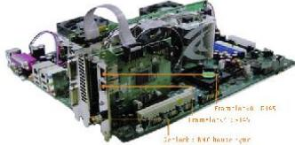
Genlock機能により、他のデバイスと共にスクリーンドリップルフォーマット及び House-Sync フормレートによる同期が可能。ボスプロダクション、ブロードキャスティングに最適なリソーシングを提供します。Frame lock機能により、複数のPCを使用したクラウドレンジングシステムにおいて、グラフィックス端の同期が可能になります。複数のPCで同時に3D映像の表示が可能になります。
