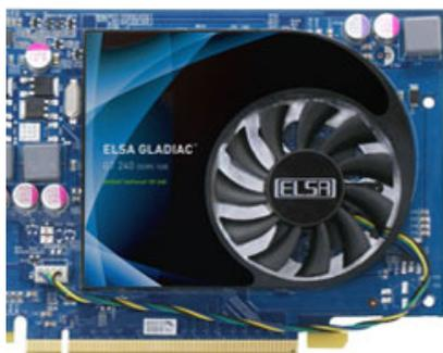
高性能な1スロットサイズの静音ファンを採用し、拡張スロットの数が少ないPCにも最適です。PWMコントローラを搭載したファンは、グラフィックスプロセッサの温度情報を監視し、ファンの回転数を自動的に調整することで、ファンノイズを押さえ優れた静音性を実現します。
