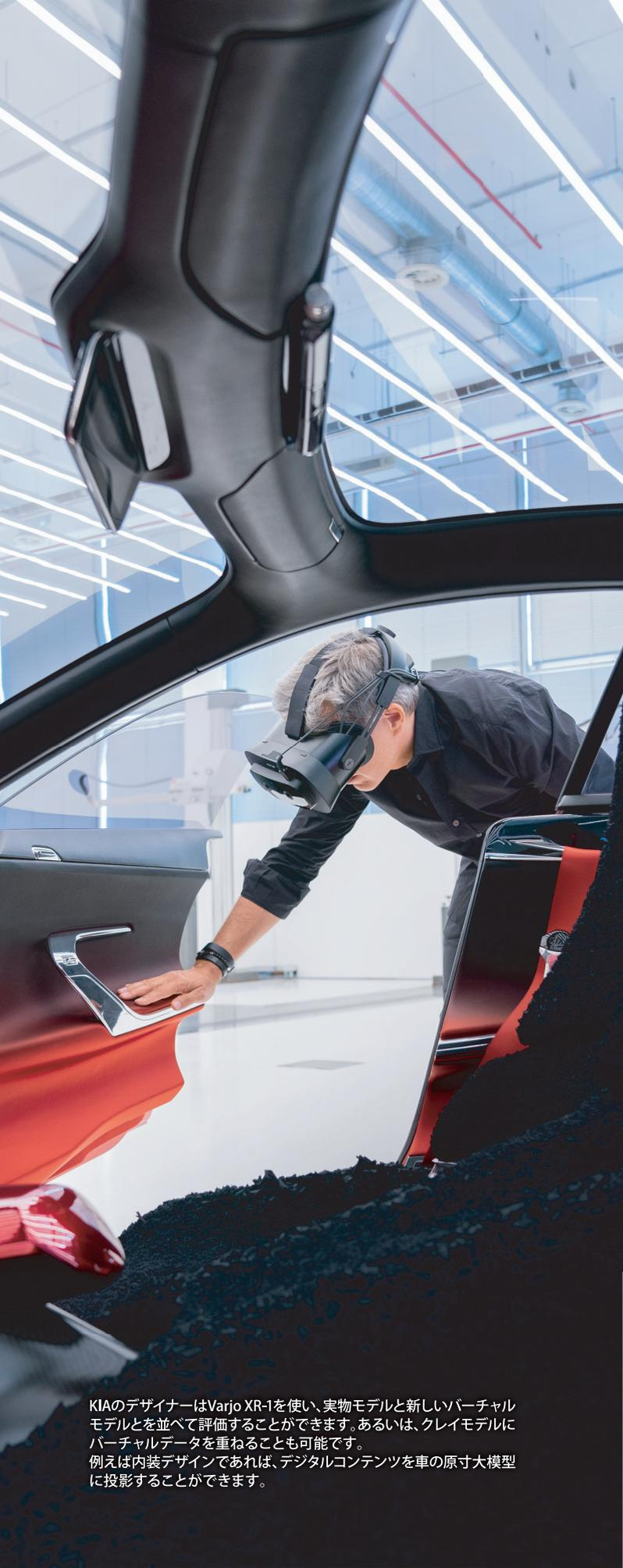
KIAのデザイナーはVarjo XR-1を使い、実物モデルと新しいバーチャルモデルとを並べて評価することができます。あるいは、クレイモデルにバーチャルデータを重ねることも可能です。例えば内装デザインであれば、デジタルコンテンツを車の原寸大模型に投影することができます。
