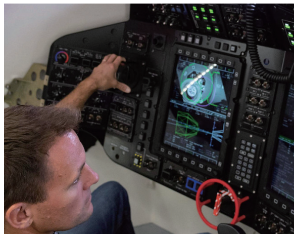
CST-100スターライナーの操縦席には2つのディスプレイがあり、宇宙船の速度と軌道をリアルタイムで表示しています。
