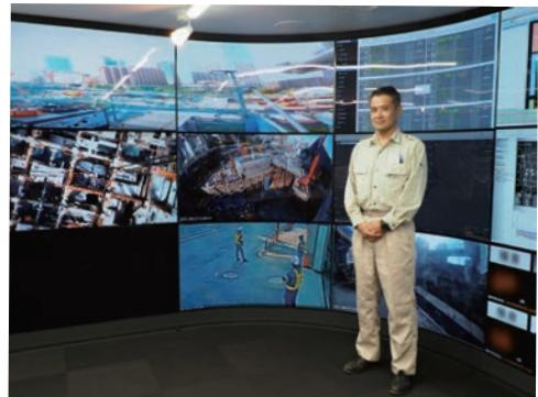
▲ 清水建設が都内の大規模建築現場に導入したSCCとその前で説明をする清水建設東京支店大規模建設所建設所長の井上慎介氏。SCCは現在33面の55型ディスプレイで構成しているがそのうち部屋の角にあたる2カ所12面は曲面ディスプレイを採用している
