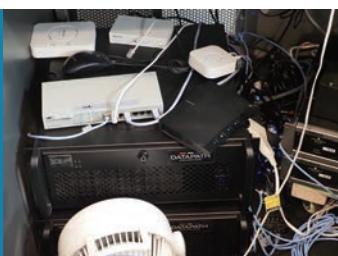
机の下に二台重ねて置いてあるDatapath VSNのうち、上は本体の「VSN1182-RPSU」で下は拡張ユニットの「VSN1100X-RPSU」だ。本体と拡張ユニットで合わせて4K×2系統入力対応キャプチャーカード「VisionSC-UHD211枚とフルHD×4系統入力対応キャプチャーカード「VisionSC-HD4+/H」8枚、4系統出力対応グラフィックスカード「ImageDP4+」を9枚搭載する
